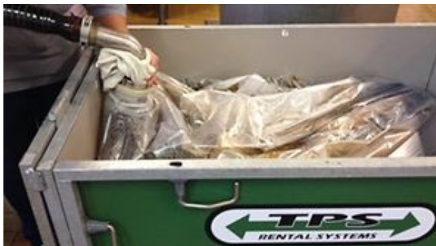
Med det nye system kan 500 kilo flydende lakrids tappes direkte fra plastposen i containeren til produktionsanlægget. Foto: Scagro
